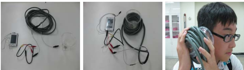
[그림42] 대전류 실험장치를 사용한 스피커 실험
