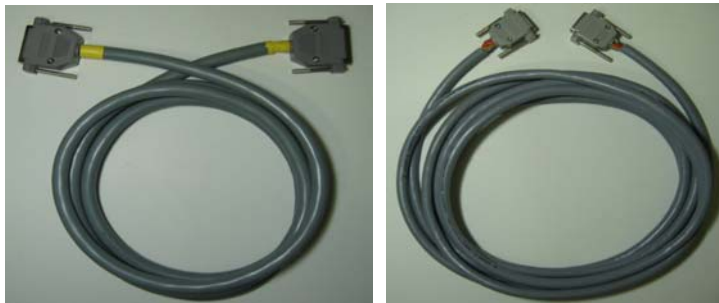
[그림21] 최종작품(25가닥,2.5m) [그림22] 최종작품(15가닥,5m)
