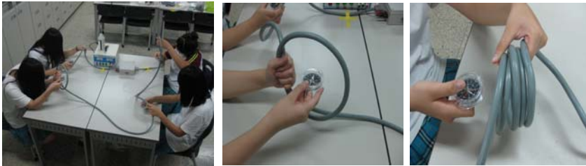
[그림34] 개별화 실험 [그림35] 원형 · 코일에 의한 자기장 실험
