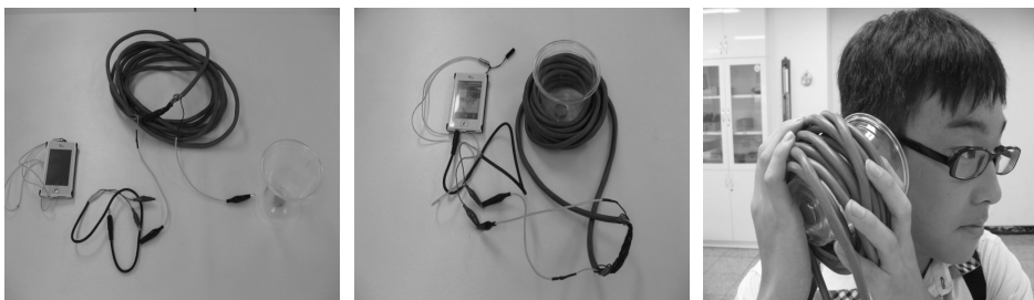
[그림42] 대전류 실험장치를 사용한 스피커 실험
